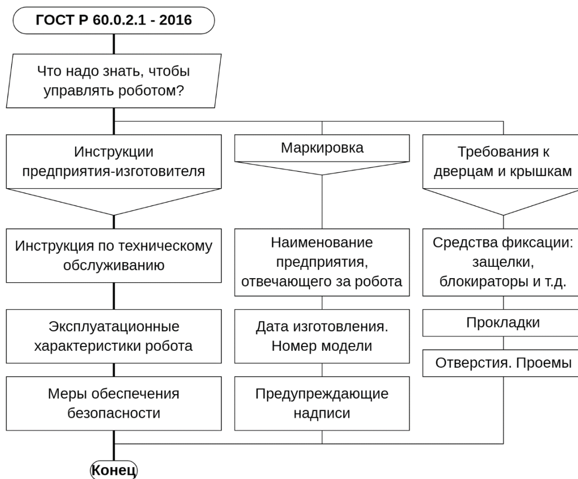
Рис. 1. Требования техники безопасности Fig. 1. Safety requirements
