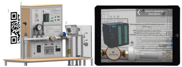
Рис. 3. Мобильный помощник: 1 – мишень; 2 – виртуальная модель лабораторного комплекса; 3 – приложение для мобильного телефона
