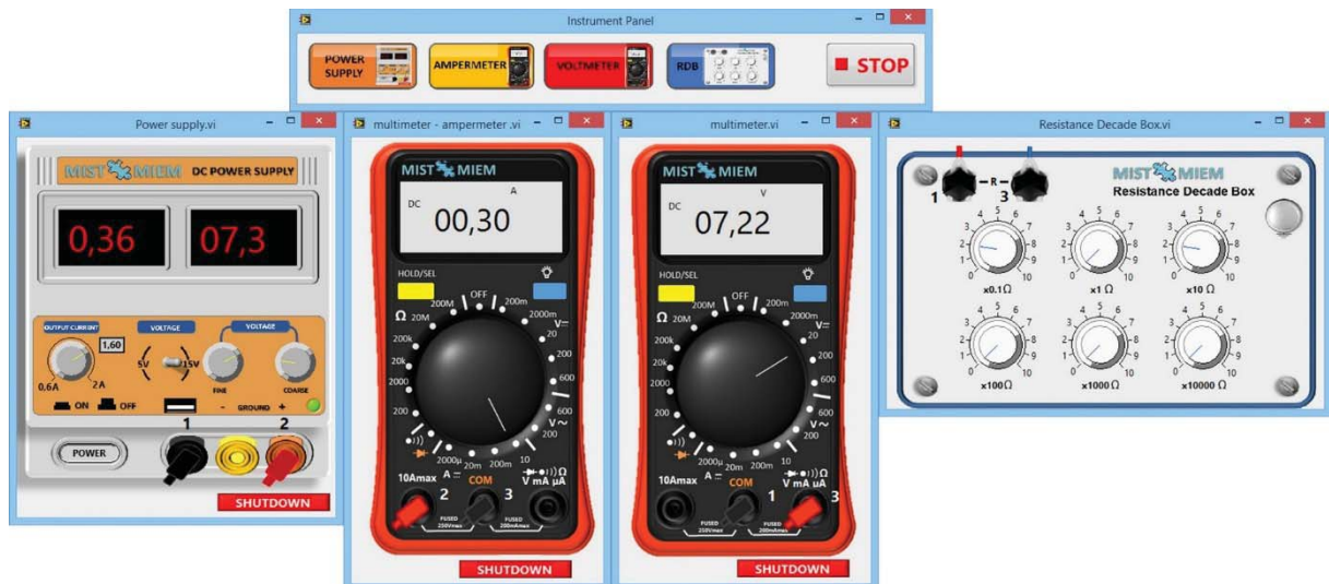
Рис. 3. Виртуальный лабораторный стенд для измерения мощности постоянного тока Fig. 3. Virtual laboratory stand for measuring DC power
