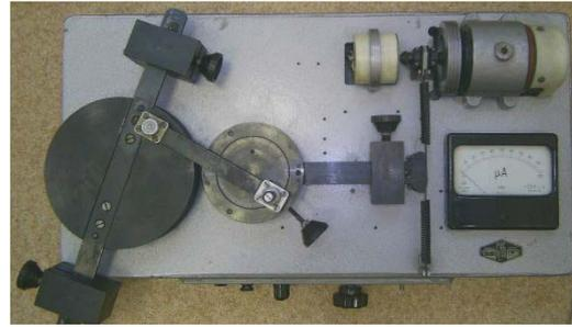
**Рис. 4.** Модель установки кривошипно-коромыслового механизма
