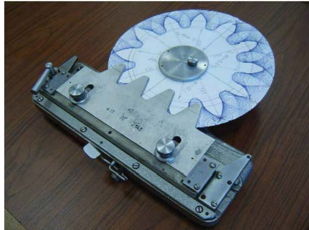
Рис. 10. Моделирование процесса нарезания зубчатых колес
