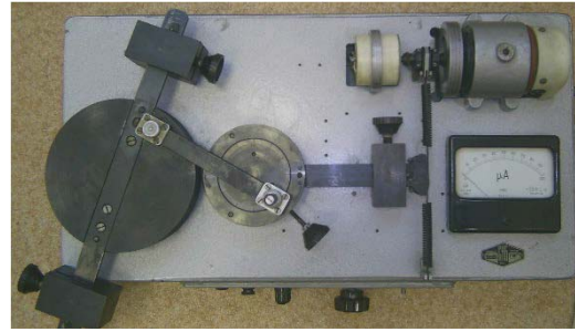
Рис. 4. Модель установки кривошипно-коромыслового механизма
