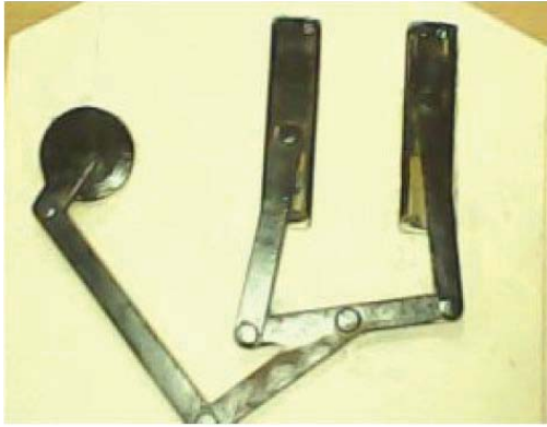
Рис. 1. Модель и кинематическая схема механизма Морган Fig. 1. Model and kinematic diagram of the Morgan mechanism
