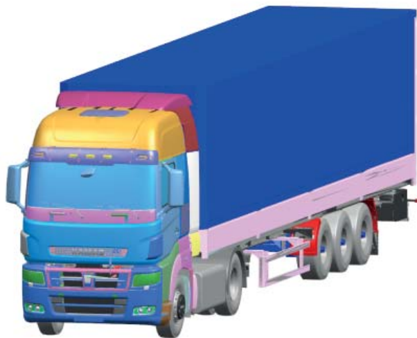
Рис. 2. Многомассовая модель КТС Fig. 2. The multibody model of the CCC
