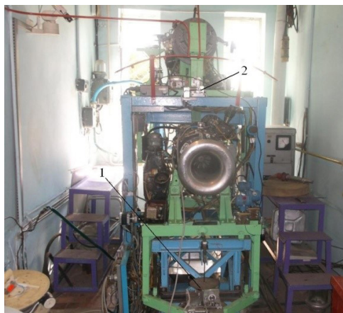
Рис. 2. Схема установок для испытаний ТС-12 (а) и ДГ-4М (б): 1 – двигатель; 2 – лемнискатный насадок; 3 – подвижная платформа; 4 – гибкие стальные ленты; 5 – станина станка; 6 – выхлопная труба; 7 – элементы крепления двигателя на стенде; 8 – силоизмерительный датчик; 9 – редуктор двигателя; 10 – электрический генератор
