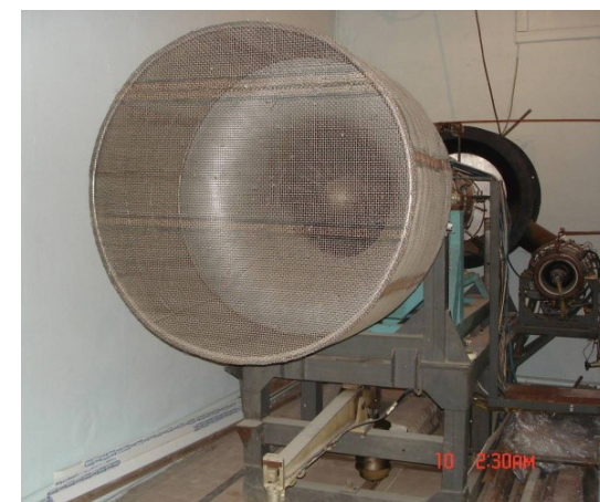
Рис. 3. Расположение ТРД АИ-25 и ВГТД АИ-9 в боксе стенда
