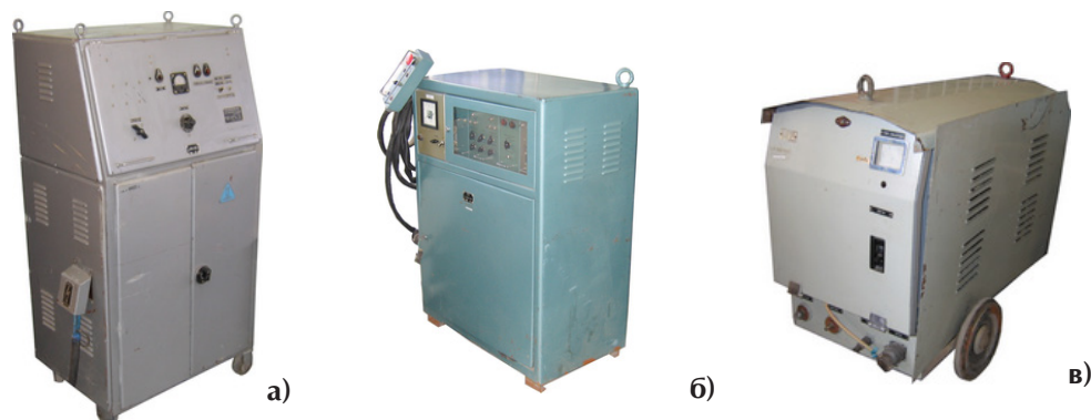
Рис. 3. Источники питания ИПК-350 (а), ИСВУ-80(б), ТИР-300(в)
