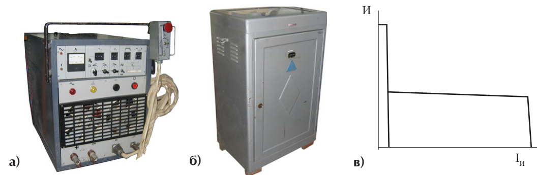
Рис. 5. Внешний вид сварочного выпрямителя ВСВУ-400 (а), ВСВУ-160(б) и внешние вольтамперные характеристики (в)
