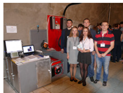
б) Ветро-солнечно-дизельная генерирующая установка 1 кВт
