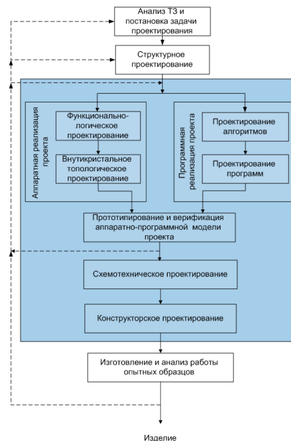
Рис. 1. Технологический цикл проектирования устройств цифровой обработки информации на ПЛИС и СП
