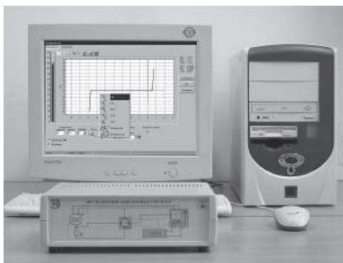
Рис. 3. Автоматизированные комплексы для исследования вольт-амперных (а) и вольт-фарядных (б) характеристик микросистем
