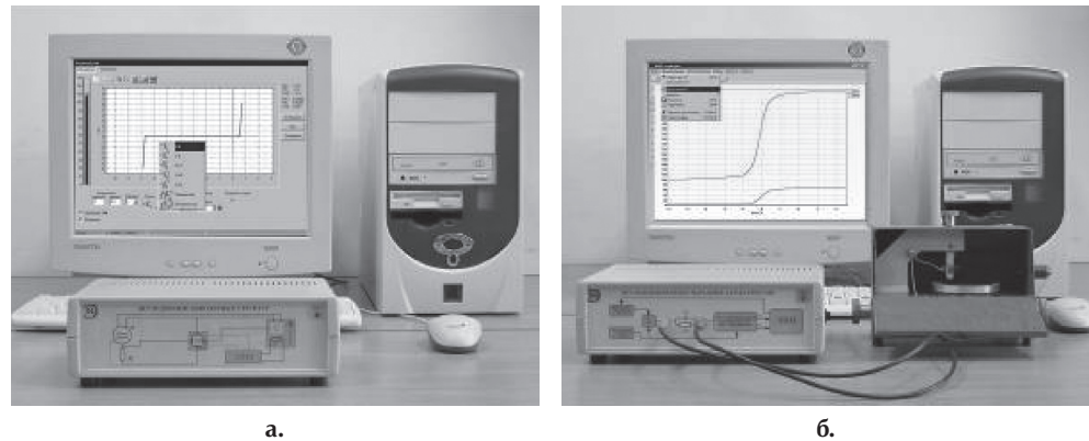
Рис. 4. Автоматизированный комплекс для исследования свойств однокомпонентных и многокомпонентных проводниковых материалов.
